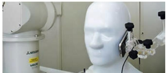
Messung von elektromagnetischen Feldern am Kopf.
